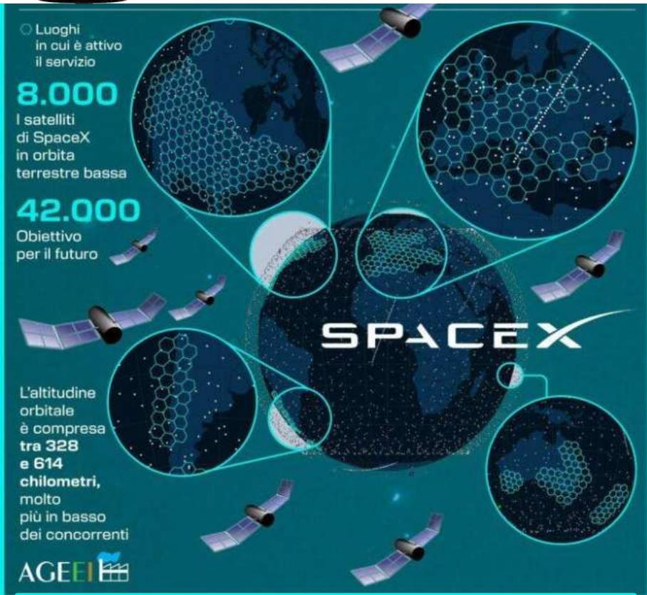
**Concetto di base:** Starlink sfrutta un'ampia costellazione di satelliti in orbita terrestre bassa (**300-1000 Km.**) per fornire connessioni internet ad alta velocità e bassa latenza.
